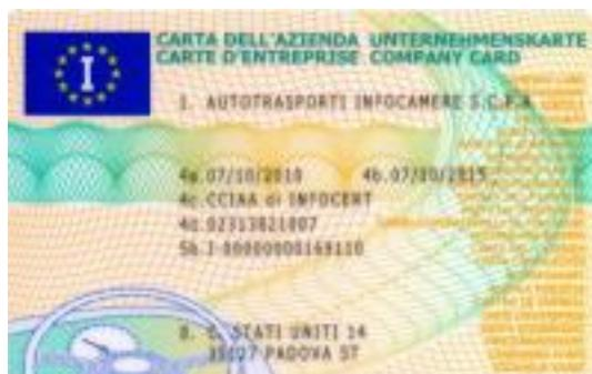
La carta dell'Azienda identifica la Società proprietaria dei mezzi, facilita la gestione della flotta veicolare e consente di ispezionare, scaricare e/o stampare i dati di viaggio di tutti i veicoli dell'azienda muniti di tachigrafo digitale.
